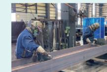
鋼材を切断・組立・溶接・検査し、製品を作成します。
